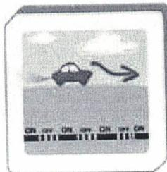
Numa estrada plana, só uma parte da potência é necessária para manter a velocidade. Como resultado, pode-se reduzir a aceleração, usando pouca energia.
